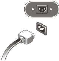
**Abbildung 3. Anschließen der Stromversorgung**
